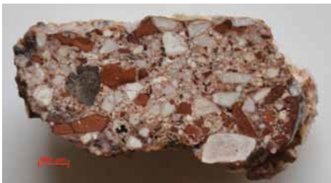
10. kép. A nucleus felső rétegének keresztmetszetén jól megfigyelhető a töltőanyagok (téglatörredék és dolomit szemcsék) morfológiája.
