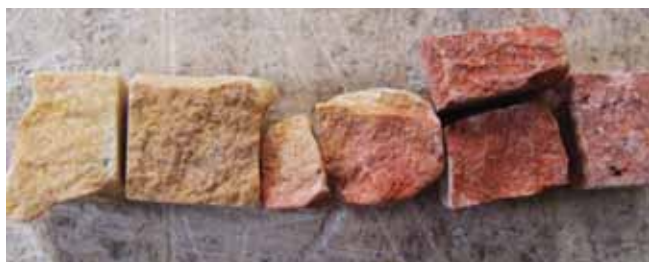
6. kép. A vörösödés jelenségének modellezése újonnan tört köveken.
