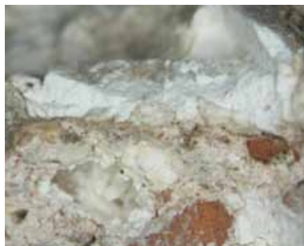
11. kép. A supranucleus és a nucleus felső rétege mészcsonóval, sztereo-mikroszkópos felvételen.
