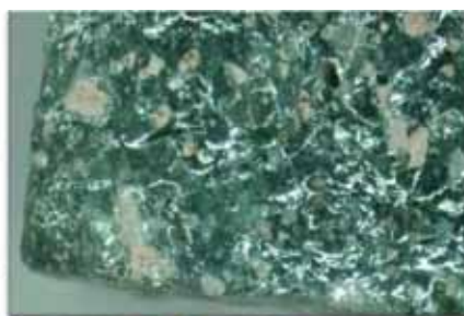
10. kép. A vörös színt adó fém réz részecskék sávosan rendeződnek el az üveg alapanyagban (Szfv_1), hol feldúsulva, hol kisebb mennyiségben vannak jelen. (PLM, az objektív nagyítása 40x).
