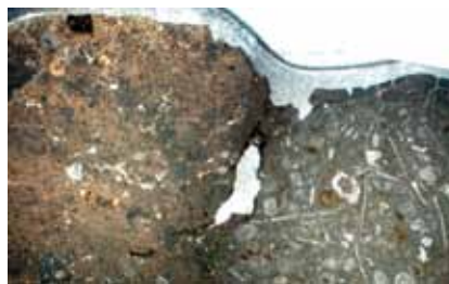
4. kép. A mészbázisú beágyazó vakolat mészkő töltőanyagot is tartalmaz, melynek szövet-szerkezete is megfigyelhető. (PLM, 1N).
