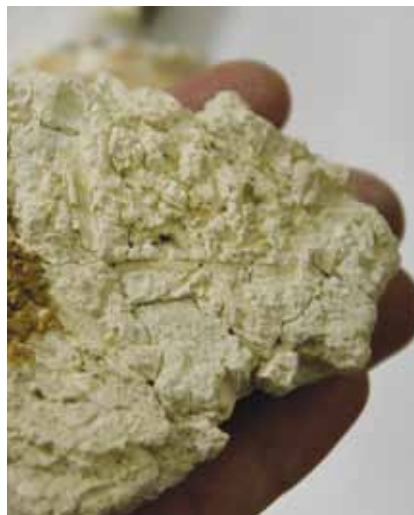
5. kép. Az alapvakolat struktúrája, növényi részletek lenyomata a beágyazó vakolat hátoldalán. Székesfehérvár, Szent István Király Múzeum, ltsz.: 718.
